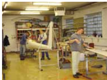
Teamarbeit im Verein: Der alte Lack des „Fliegers“ muss runter.
